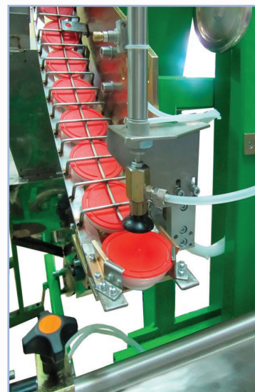
Automatic lids orientator and layer on the same position Автоматический ориентатор крышек и укладчик на одной позиции
